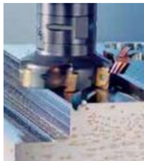
Einfahrt per „Roll-In“ Verfahren Verschleiß nach 800 Bearbeitungsgängen
