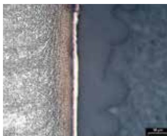
Diffusionszone, keine Verbindungsschicht
