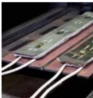
Verwendung von Heizmatten
