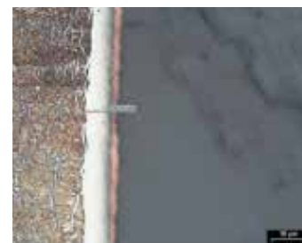
Diffusionszone, Verbindungsschicht 36 µm
